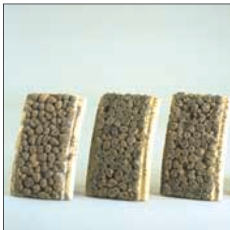
Leca del tipo Resistente e Strutturale (sopra), Basalto e Calcare (sotto) assoggettati ad usura in laboratorio.
