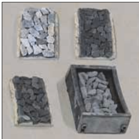
Leca del tipo Resistente e Strutturale (sopra), Basalto e Calcare (sotto) assoggettati ad usura in laboratorio.
