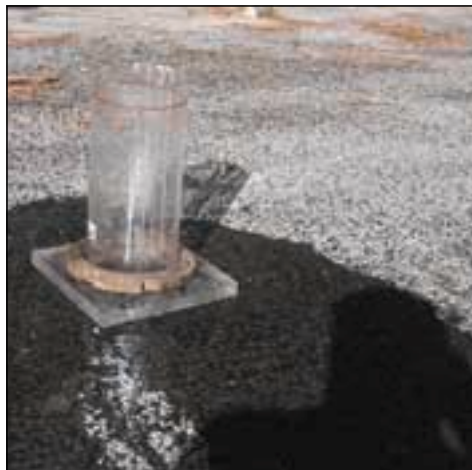
Prova di capacità drenante.
