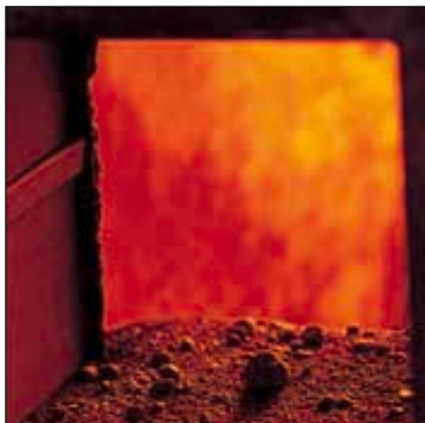
La cottura a 1200 °C e il processo di espansione.
