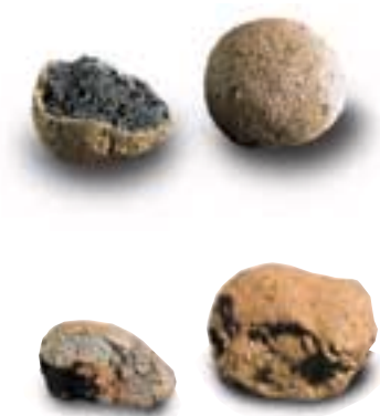
Granuli di Leca (in alto) e Leca Strutturale (in basso): la struttura porosa del materiale costituente il granulo è racchiusa in una scorza dura e resistente.
