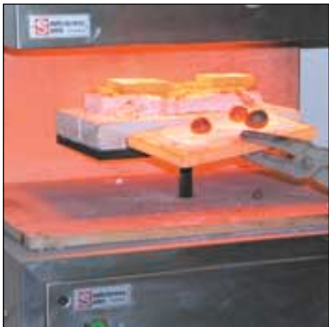
Controllo dell'espansione del granulo di argilla espansa.
