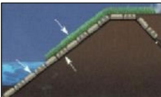
La presenza di zone vuote, di una certa dimensione, tra i vari blocchi e all'interno di essi consente al rivestimento di essere permeabile integrandosi quindi in maniera naturale con il terreno circostante al quale assicura gli scambi sia in ingresso che in uscita.
